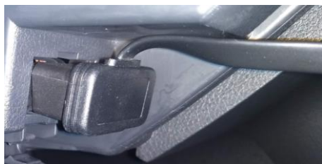
Obr. 4.3 Použitie predlžovacieho kábla v diagnostickej zásuvke vozidla
