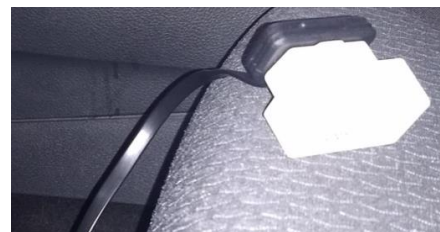
Obr. 4.4 Použitie predlžovacieho kábla vozidla v diagnostickej jednotke ELM 327
