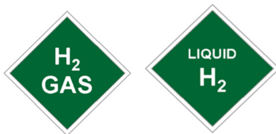
Obr. č. 9: Príklad označenia vozidla s pohonným systémom na stlačený (plynný) vodík a skvapalnený vodík
