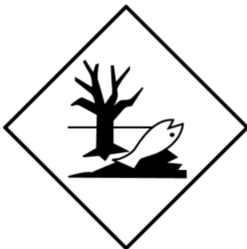
Obrázok č. 5: Značka pre látky ohrozujúce životné prostredie Symbol (ryba a strom): čierne na bielom alebo vhodnom kontrastnom pozadí
