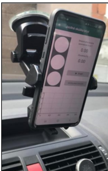
Meranie spomalenia vozidla aplikáciou mSTK.
