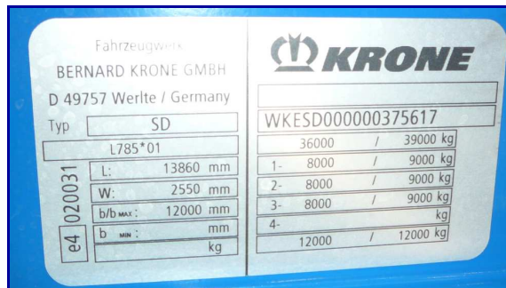
Vľavo samostatný štítok rozmerov motorového vozidla, vpravo spoločný výrobný štítok a štítok rozmerov návesu
