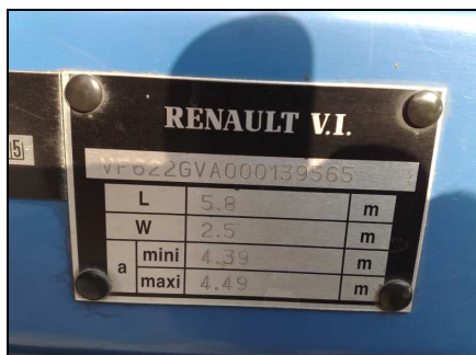
Vľavo samostatný štítok rozmerov motorového vozidla, vpravo spoločný výrobný štítok a štítok rozmerov návesu
