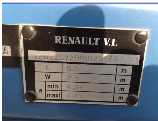
Obr. č. 5. Príklad štítku rozmerov ťahača návesov Renault Magnum.
